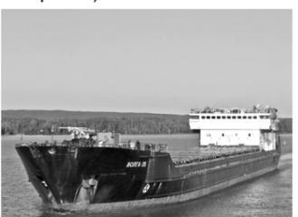
**30 лет (1986)** со дня спуска на воду **головного судна пр.19610 «Волга»**. Всего построено 45 сухогрузных теплоходов этого проекта. Это большие сухогрузные суда типа река-море. Район плавания – от портов Северного и Балтийского морей по Волге и Дону – в Азовское, Чёрное, Средиземное море и обратно.
