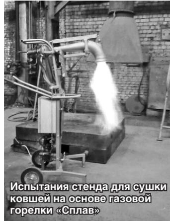
Испытания стенда для сушки ковшей на основе газовой горелки «Сплав»
