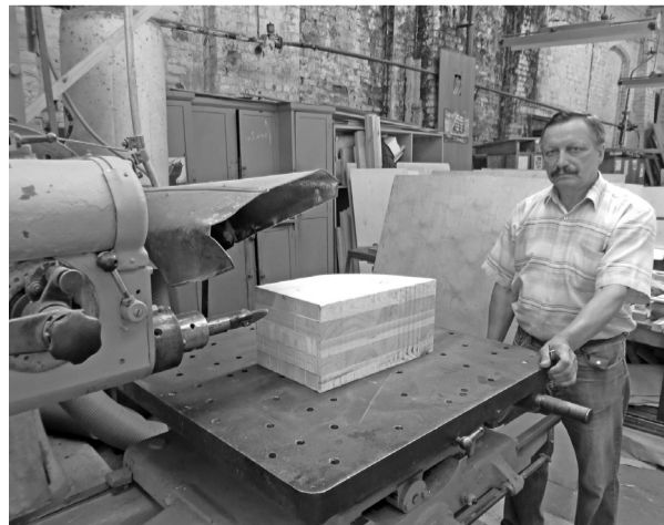
Мастер А.А. Беньяхин за работой на горизонтально-вертикальном фрезерном станке английской фирмы «Vadkin Ltd.». При изготовлении стержневых ящиков без этого станка-ветерана не обойтись
