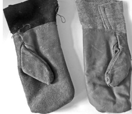
Вачеги обладают повышенной плотностью и прочностью. Верх этих рукавиц – кожаный спил толщиной 1,1-1,4 мм. Основа – шинельное сукно плотностью 760 граммов на квадратный метр. Эти материалы обеспечивают жаропроницаемость и высокую стойкость к прожиганию, а также удобство и основательную защиту рук от повреждений, которые могут нанести искры, брызги металла,
