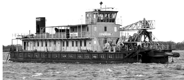
Назначение земснаряда «Сормовский»: поддержание и увеличение глубины судоходных рек, прокладка новых водных путей, намывка грунтом берегов, строительство плотин и проведение других гидротехнических работ. Длина судна – 44,5 м, ширина – 9,5 м; силовая установка – 350 л.с. Производительность на песчаном или песчано-глинистом грунте – 350 м³/час.
