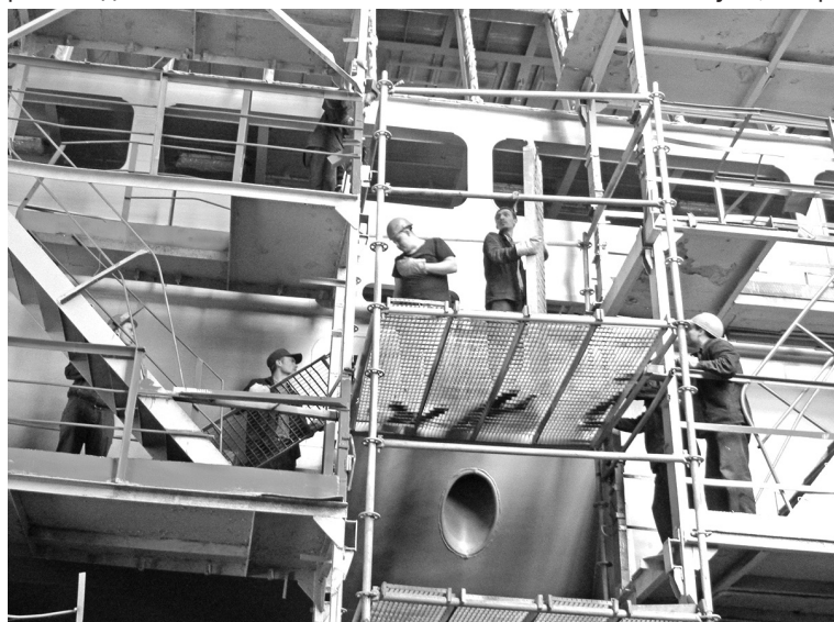
Кормовая оконечность судна в стапельных лесах
