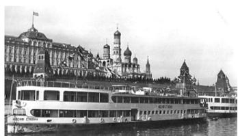
**80 лет назад** – в апреле 1937 года, на заводе была построена **флотилия судов к открытию канала «Москва-Волга»** – 16 первоклассных пассажирских теплоходов и катеров. **Впервые в стране** корпуса теплоходов такой большой мощности (700 л.с.) были изготовлены цельносварными.
